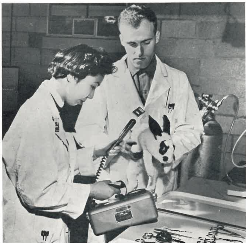
Geiger-teljari notaður við að mæla kjarngeislun frá kanínu, sem fengið hefur skammt af geislavirku efni.
